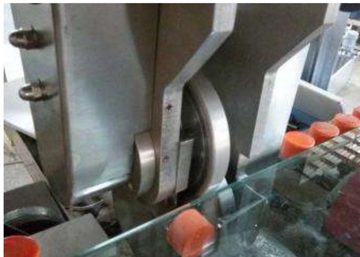
Le modèle D dispose du dispositif de compression latérale, sans rayures sur le verre low-e.
