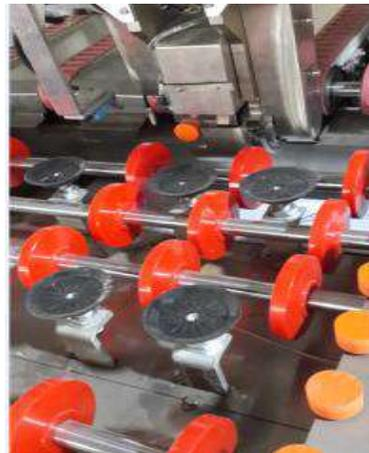
Trois têtes à doubles roues. Chaque tête a deux roues. Transmission par servomoteur: il y a 5 servomoteurs dans le modèle, avec une liaison à 4 axes. Identification automatique de la taille du verre, de son épaisseur, de sa largeur et de son orientation.
