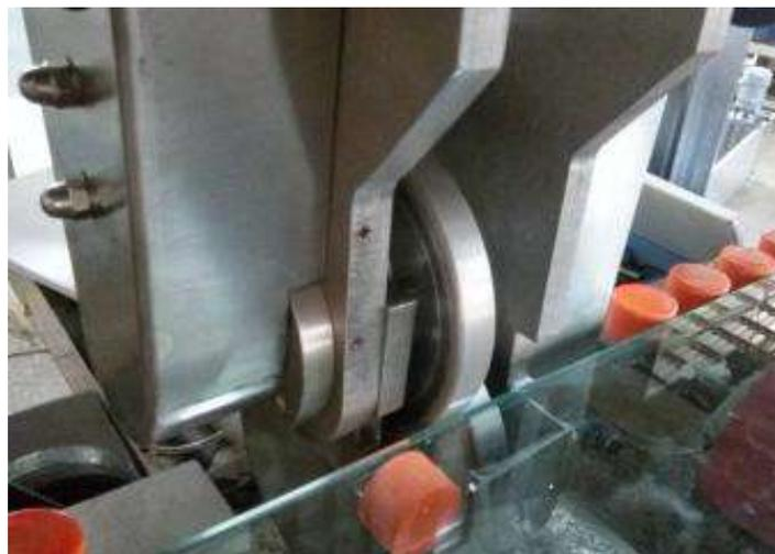
O modelo D tem o dispositivo de compressão lateral, sem arranhões no vidro low-e.
