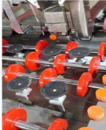
Três cabeçais com rodas duplas. Cada cabeçal tem duas rodas. Transmissão por servomotor: existem 5 servomotores no modelo, com link de 4 eixos. Identificação automática do tamanho, espessura, largura e orientação do vidro.
