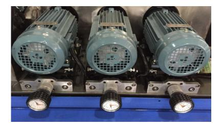
**5** - Les moteurs de chant sont ABB, ils sont capables de garantir une grande quantité de dégrossissage du verre et d'augmenter la vitesse d'avancement du verre. Le premier moteur est de 3 CV.
