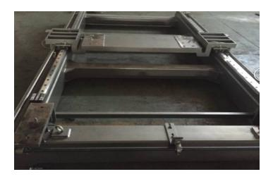
2 - Système de transport du verre avec servomoteurs indépendants (sans barre de transmission), avec vitesse d'avance de 1 à 15 Mme / min. (Schneider)
