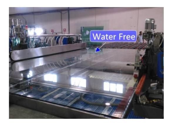
**11** - Sangles de transport en verre pour low-e. Avec ces sangles, les rayures sur le verre sont évitées. Le remplacement des courroies est très simple car elles n'ont pas de timon. Il dispose d'une brosse pour nettoyer les courroies supérieures et inférieures.
