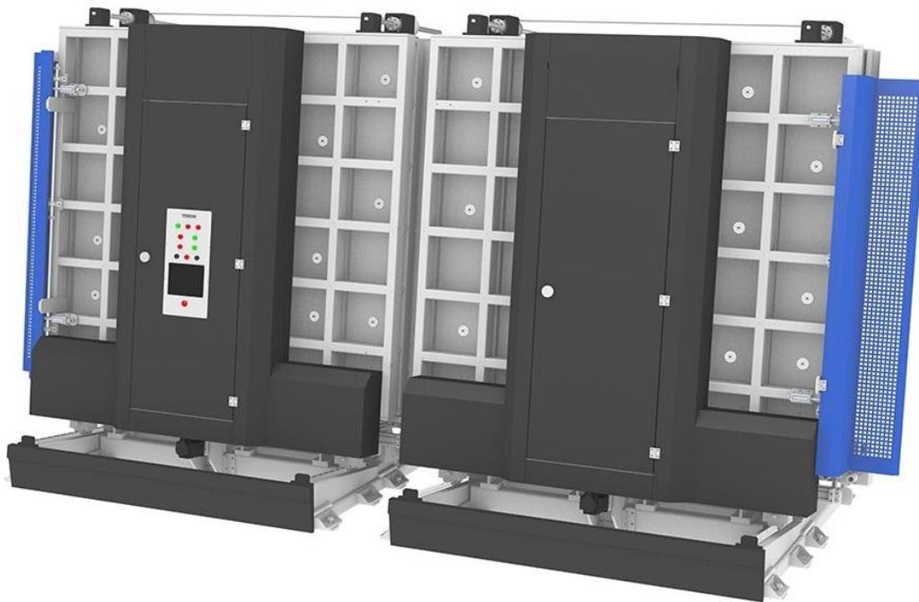
Système entièrement automatisé pour le remplissage, l'assemblage et le pressage de gaz des unités isolantes. Le gaz est introduit par le bas, ce qui réduit la turbulence à zéro et la barre d'amortissement de mouvement minimisera la consommation de gaz.
