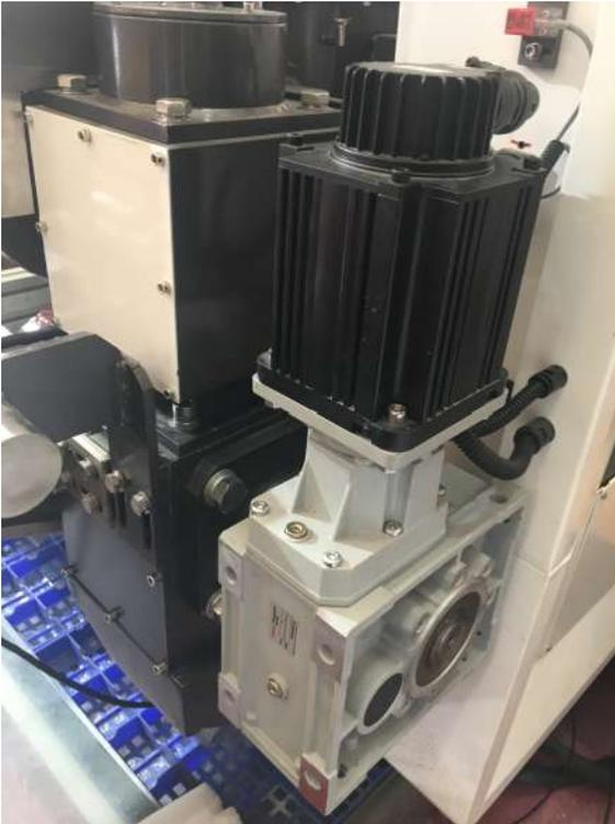
3-La apertura y cierre de las bancadas se realiza con guías y patines de precisión. Esta apertura se realiza a alta velocidad 12m/min. Para reducir el tiempo de cambio de medida. El posicionamiento final es de alta precisión controlado por encoders. Este proceso se puede automatizar mediante lector de código de barras.
