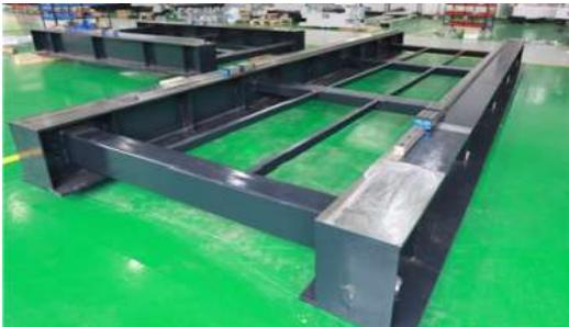
2-Sistema de transporte del vidrio con servo motores independientes ( sin barra de transmisión), con velocidad de avance de 1 a 15 Mrs./min.(Schneider)
