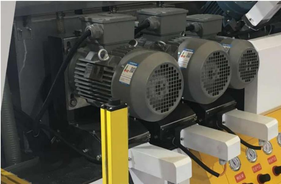
5-Los motores para el canteado ( Siemens) giran a 4000 RPM /min. Lo que garantiza una alta cantidad de desbaste del vidrio y aumentar la velocidad de avance del vidrio.Los dos primeros motores son de 5 CV.
