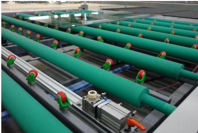
Une fois le verre passé sur la table d'impression, plusieurs butées sont automatiquement activées pour placer le verre dans sa position avec une grande précision.
