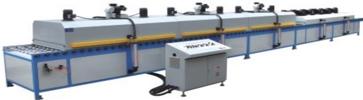
Le four de séchage du verre est un équipement auxiliaire de la machine d'impression sur verre entièrement automatique, qui est utilisé pour sécher le verre après l'impression. La vitesse de transport peut être ajustée automatiquement. La température de séchage peut être ajustée de ou jusqu'à 250°C. Les rouleaux de transport du verre sont recouverts de kevlar.
