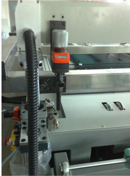
Système automatique d'élévation latérale de l'écran. Lors du passage de la spatule, le châssis remonte grâce à ce système, ne permettant que le point où l'encre est injectée d'être en contact avec le verre. Cela évite les taches et les distorsions lors de l'impression. Automatique (facultatif).
