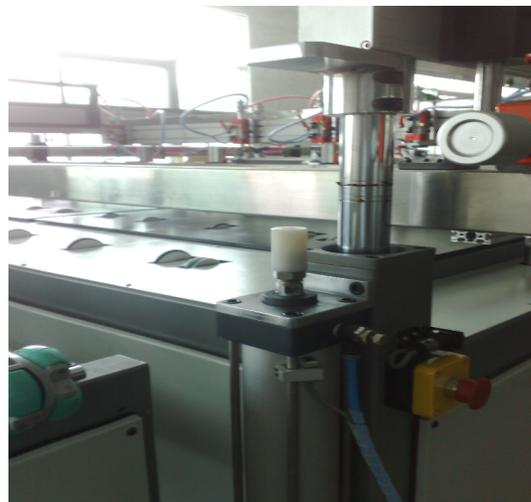
L'écran se place très facilement sur la structure du châssis au moyen de pistons qui le maintiennent pneumatiquement.
