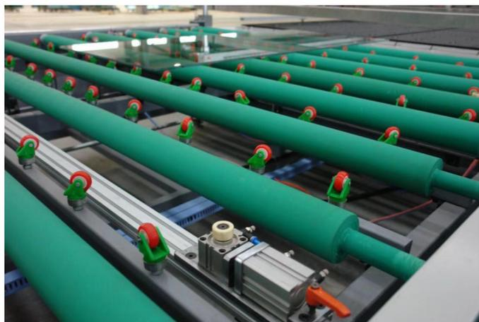
Uma vez que o vidro passa para a mesa de impressão, várias paradas são acionadas automaticamente para colocar o vidro em sua posição com grande precisão.
