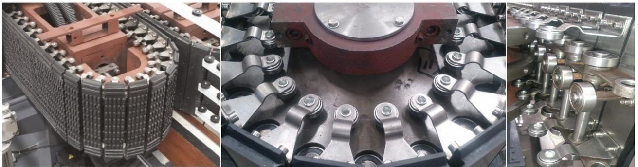
Correas dentadas en los transportes de entrada y de salida.
