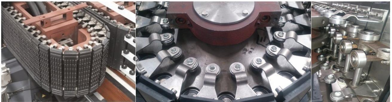
Courroies dentées dans le transport d'entrée et sortie. Elévation du banc d'entrée pour réglage de l'épaisseur à soumettre à dégrossissage.
