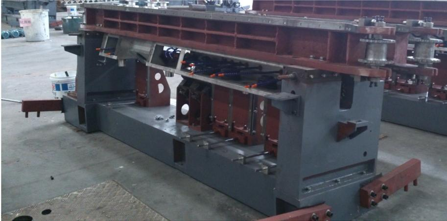
Chaîne de transport de verre avec des joints en caoutchouc. Le transport est réalisé avec des guides et des roulements pour supporter le poids et la position du verre. Les guides assurent que l'arête soit parfaitement droite. En outre, l'entretien de ce système est très simple.
